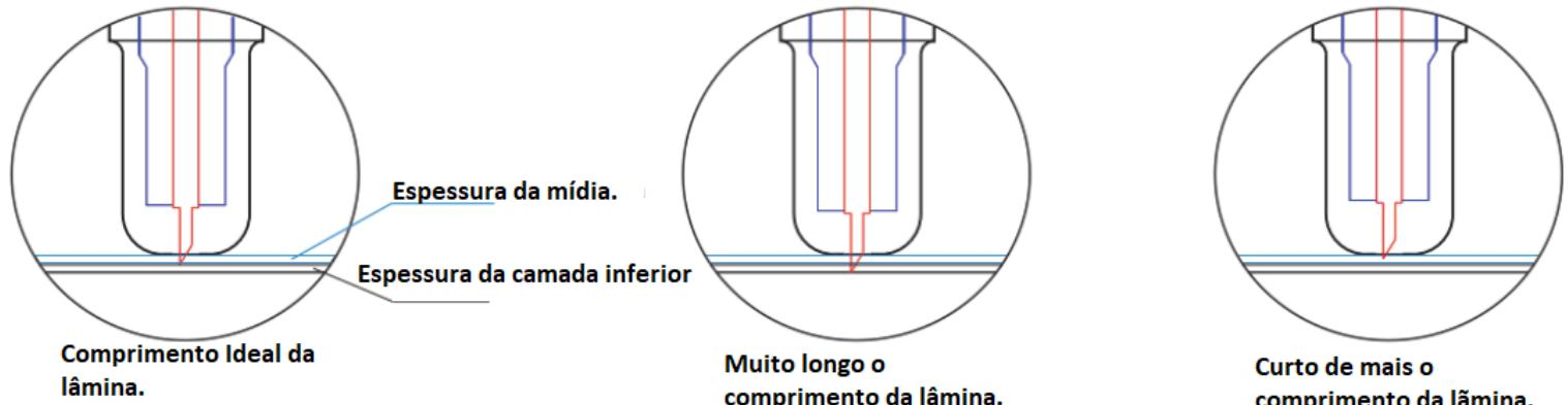
**7.3 - Pressione a haste da lâmina quando substituir a lâmina.**
